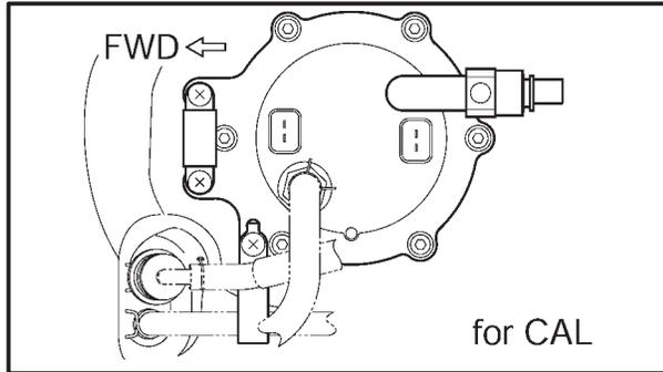
**INSTALLING THE FUEL PUMP**
